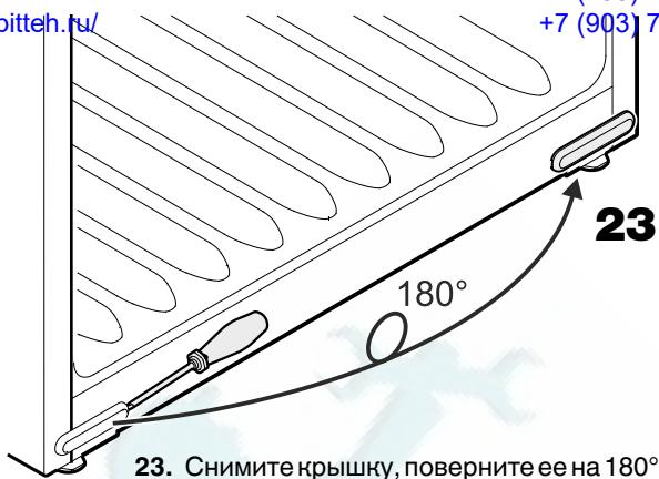
23. Снимите крышку, поверните ее на 180° и снова вставьте на противоположной стороне.
