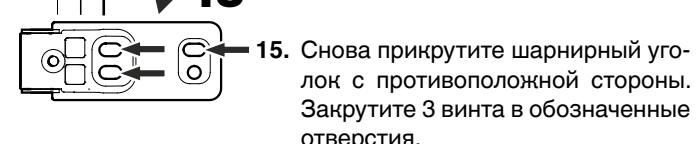
15. Снова прикрутите шарнирный уголок с противоположной стороны. Закрутите 3 винта в обозначенные отверстия.
