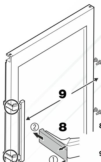
8. Вытащите спереди прижимные пластины ① и снимите их, потянув назад ② .
