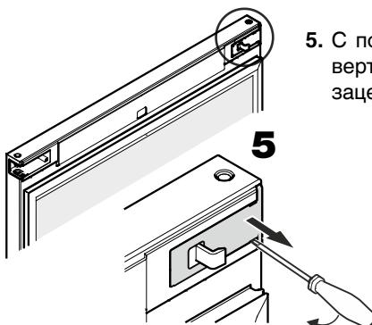
5. С помощью небольшой отвертки выведите крышку из зацепления и снимите ее.
